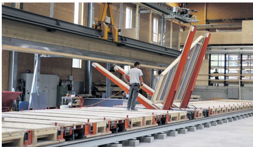
Auf der neuen Produktionsstrasse können die Holzelemente auch gedreht werden.
