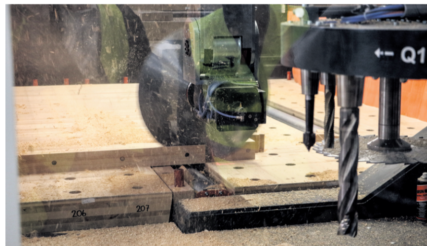
Die «TW Mill E» bearbeitet ein Holzelement.
